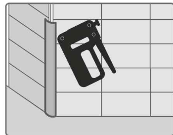
6. 코너 또는 시공이 끝나는 부분에 마감물당을 시공 합니다. 마감물당은 전용접착제(실리콘) 혹은 타카를 사용하여 부착합니다.
